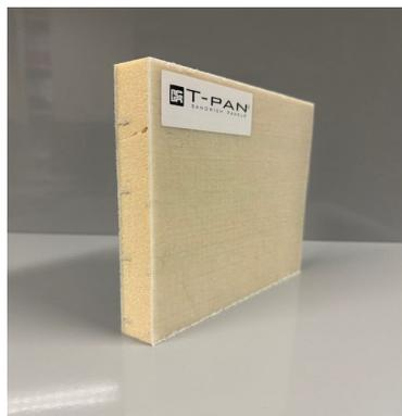
Panneau sandwich avec peaux polyester avec finition en gelcoat apte au contact avec les gendres alimentaires (sur demande du client il est possible avoir la peau polyester en différentes couleurs et tissus de verre). Âme en PVC expansé.
