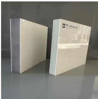
Panneau sandwich avec peaux polyester avec finition en gelcoat apte au contact avec les gendres alimentaires (sur demande du client il est possible avoir la peau polyester en différentes couleurs et tissus de verre). Âme en polyuréthane expansé haute densité.
