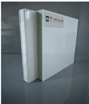
Paanneau sandwich avec peaux polyester avec finition en gelcoat apte au contact avec les gendres alimentaires (sur demande du client il est possible avoir la peau polyester en différentes couleurs et tissus de verre). Âme en PET expansé recyclé ou vierge.
