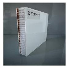
Panneau sandwich avec peaux polyester avec finition en gelcoat apte au contact avec les gendres alimentaires (sur demande du client il est possible avoir la peau polyester en différentes couleurs et tissus de verre). Âme en alvéolaire de polypropylène.
